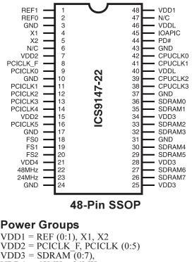
VDD4 = 48MHz, 24MHz VDDL = IOAPIC, CPUCLK (0:3)
