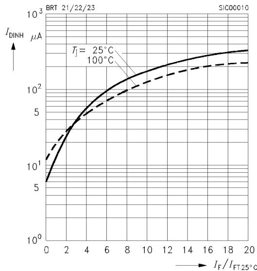
**Typ.static inhibit voltage limit** <sup>5)</sup>
