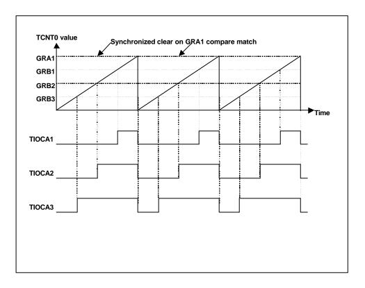
Figure 8.11 Reset-Synchronized PWM Mode Operation Example
