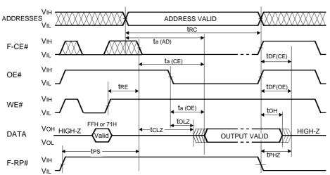
AC WAVEFORMS FOR WRITE FFH or 71H AND READ OPERATION
