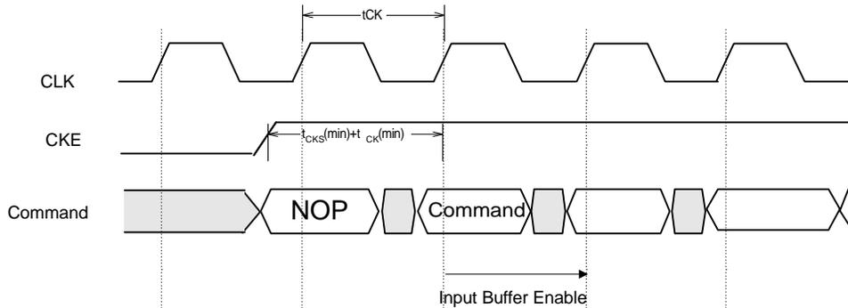
B)  $t_{CK} \geq t_{CKS}(\min) + t_{CK}(\min)$
