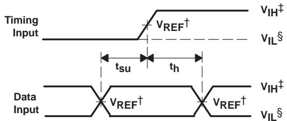
†  $V_{REF} = V_{DDQ}/2$
