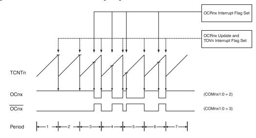
Figure 16-6. Fast PWM Mode, Timing Diagram
