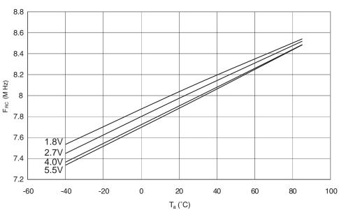
CALIBRATED 8MHz RC OSCILLATOR FREQUENCY vs. TEMPERATURE
