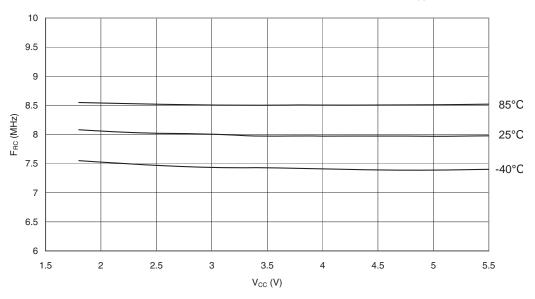
CALIBRATED 8MHz RC OSCILLATOR FREQUENCY vs.  $V_{\rm CC}$
