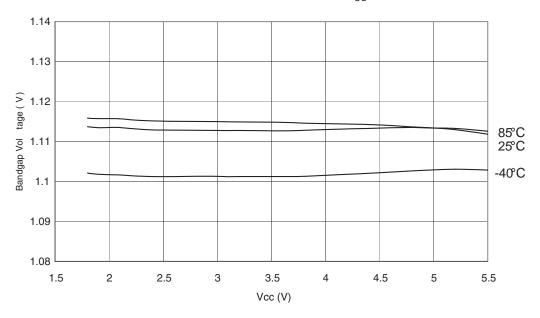
BANDGAP VOLTAGE vs. V <sub>CC</sub>
