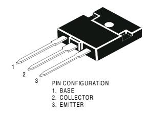
TO BE MOUNTED WITH SILICONE GREASE ON THE BACK SIDE, ENSURING BACK SIDE HOLES FILLED.
