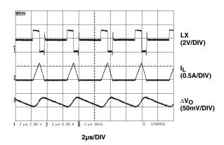
FIGURE 15. PFM STEADY-STATE OPERATION WAVEFORM (I<sub>O</sub> = 100mA)
