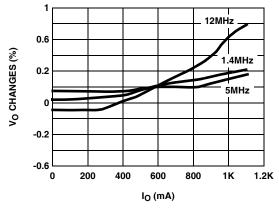
FIGURE 11. LOAD REGULATION (PWM MODE)
