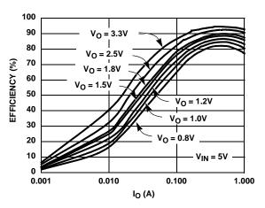
FIGURE 2. EFFICIENCY vs I<sub>O</sub> (PWM MODE)
