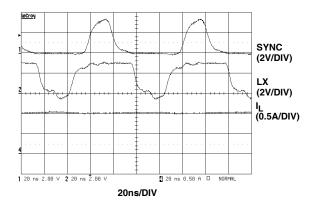
FIGURE 18. EXTERNAL SYNCHRONIZATION TO 12MHz
