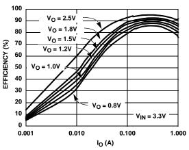
FIGURE 4. EFFICIENCY vs I<sub>O</sub> (PWM MODE)
