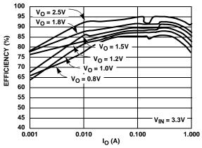
FIGURE 3. EFFICIENCY vs IO (PFM/PWM MODE)
