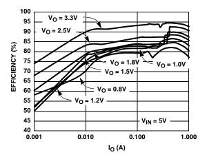
FIGURE 1. EFFICIENCY vs IO (PFM/PWM MODE)
