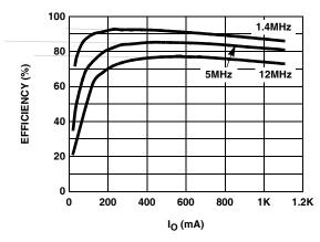
FIGURE 10. EFFICIENCY vs I<sub>O</sub> (PWM MODE)
