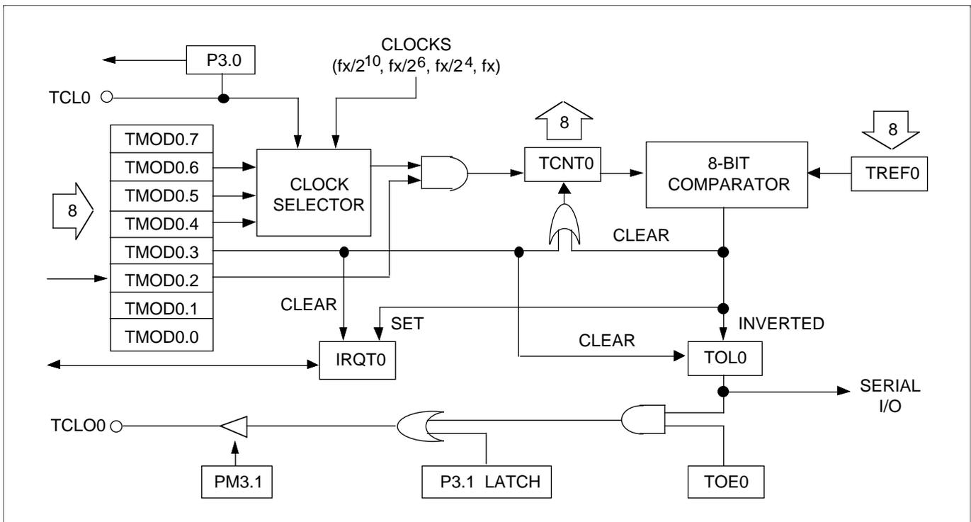
Figure 28. TC0 Circuit Diagram
