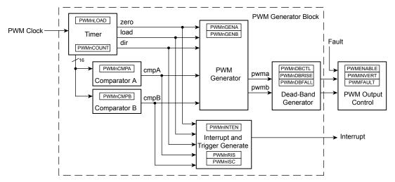
Figure 18-1. PWM Module Block Diagram
