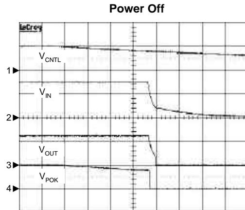
$C_{OUT}=10\mu F$ ,  $C_{IN}=10\mu F$ ,  $R_L=1.2\Omega$
