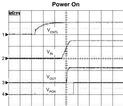
$C_{OUT}=10\mu F$ ,  $C_{IN}=10\mu F$ ,  $R_L=1.2\Omega$
