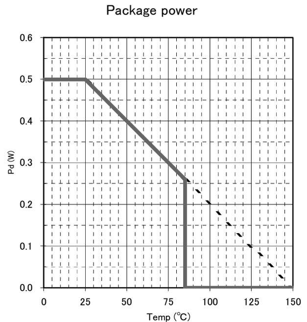
Fig. 1.2 BD8918FV/BD8919FV Power Dissipation
