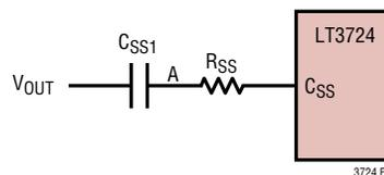
Figure 4. Soft-Start Circuit
