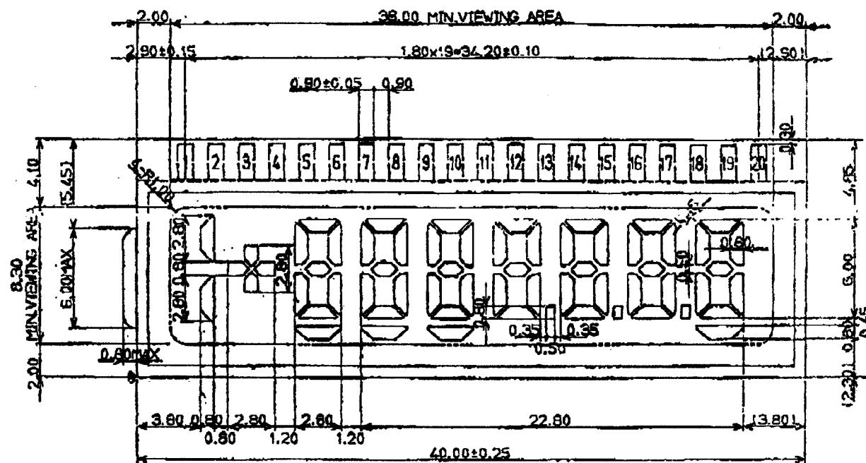
Wyświetlacz jest podłączany przez 20 pinów o rastrze 1,6 mm.
