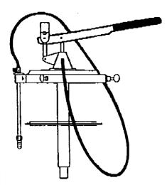
PORTABLE GREASE LUBRICATION UNITS
