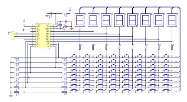
zlg7289A 应连接共阴式数码管,应用中,无需用到的数码管和键盘可以不连接,省去数码管和对数码管设置消隐属性均不会影响键盘的使用。
