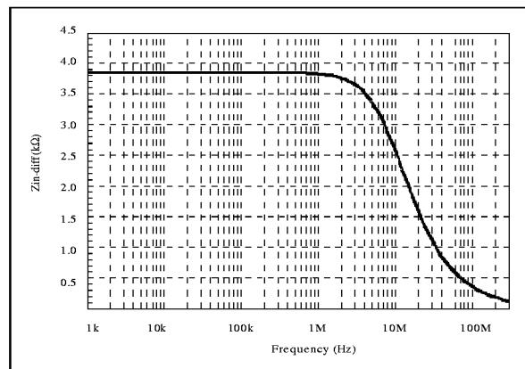
**COMMON INPUT IMPEDANCE VERSUS FREQUENCY**
