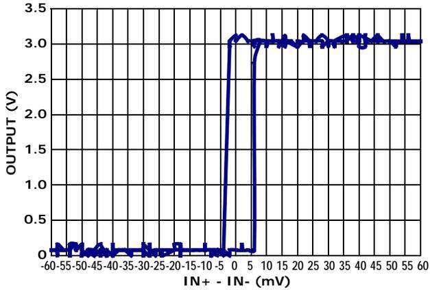
FIGURE 15. HYSTERESIS - 0mV ( $V_+ = 3V$ )
