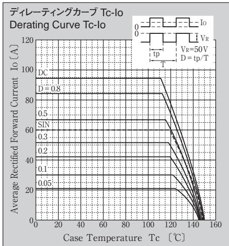
\* Sine waveは50Hzで測定しています。
