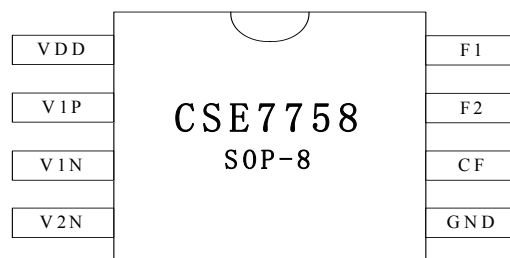
图2. CSE7758 管脚图（顶视图）
