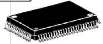
Outline 80P6N 0.8mm pitch QFP (20.0mm×14.0mm×2.8mm)
