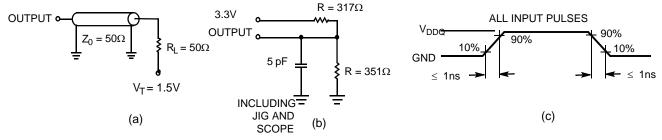
2.5V I/O Test Load
