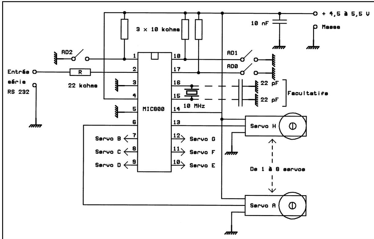
Les entrées de sélection d'adresse AD0 à AD2 sont ramenées au niveau logique haut au moyen de résistances de tirage de 10 kΩ (en pratique de 4,7 kΩ à 22 kΩ). Les interrupteurs DIL permettent de mettre au niveau bas les entrées AD0 à AD2 en fonction de l'adresse choisie (voir tableau ci-avant).
