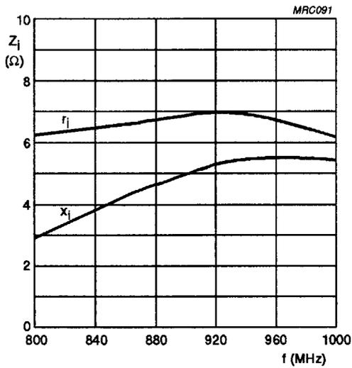
Class-B;  $V_{CE} = 7.5 \text{ V}$ ;  $P_L = 1.2 \text{ W}$ ;  $T_s \leq 60 \text{ }^\circ\text{C}$ .
