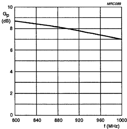
Class-B;  $V_{CE} = 7.5 \text{ V}$ ;  $P_L = 1.2 \text{ W}$ ;  $T_s \leq 60 \text{ }^\circ\text{C}$ .
