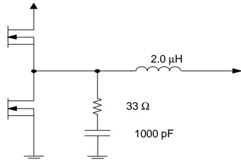
**Figure 20. Filter Components**
