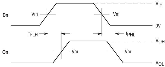
**WAVEFORM 4 - PROPAGATION DELAYS**
