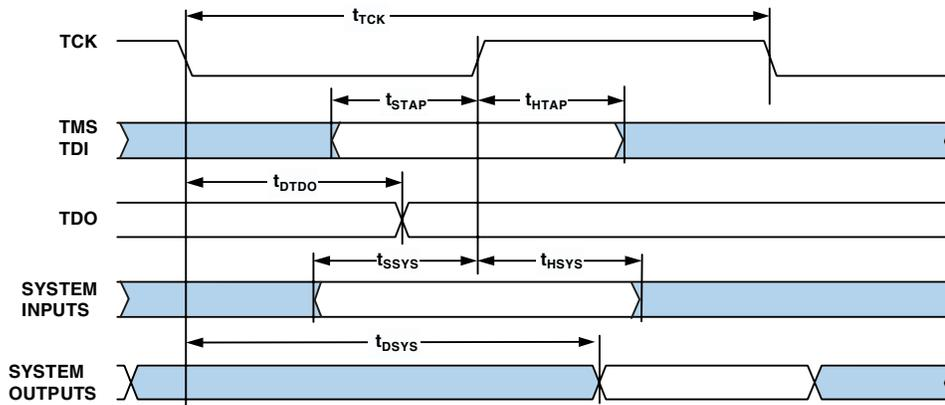
Figure 27. IEEE 1149.1 JTAG Test Access Port
