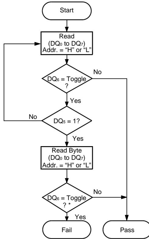
\* : DQ<sub>6</sub> is rechecked even if DQ<sub>5</sub> = "1" because DQ<sub>6</sub> may stop toggling at the same time as DQ<sub>5</sub> changing to "1".
