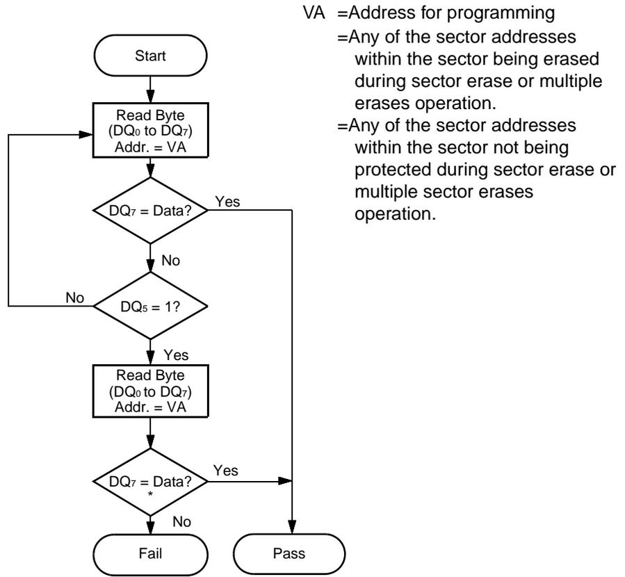
\* : DQ<sub>7</sub> is rechecked even if DQ<sub>5</sub> = "1" because DQ<sub>7</sub> may change simultaneously with DQ<sub>5</sub>.
