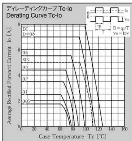
\* Sine waveは50Hzで測定しています。
