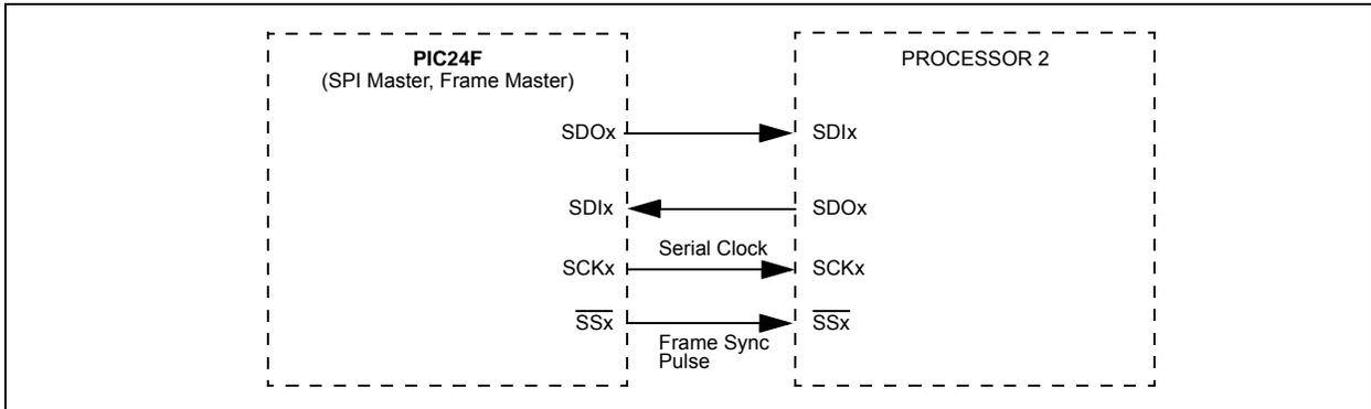
**FIGURE 15-6: SPI MASTER, FRAME SLAVE CONNECTION DIAGRAM**
