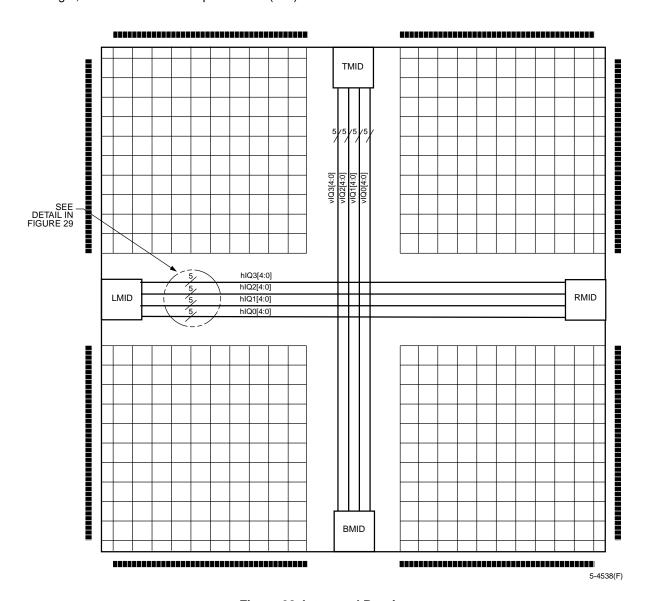
Figure 28. Interquad Routing
