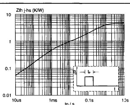
Fig.6. Transient thermal impedance per diode;  $Z_{th j-hs} = f(t_p)$ .
