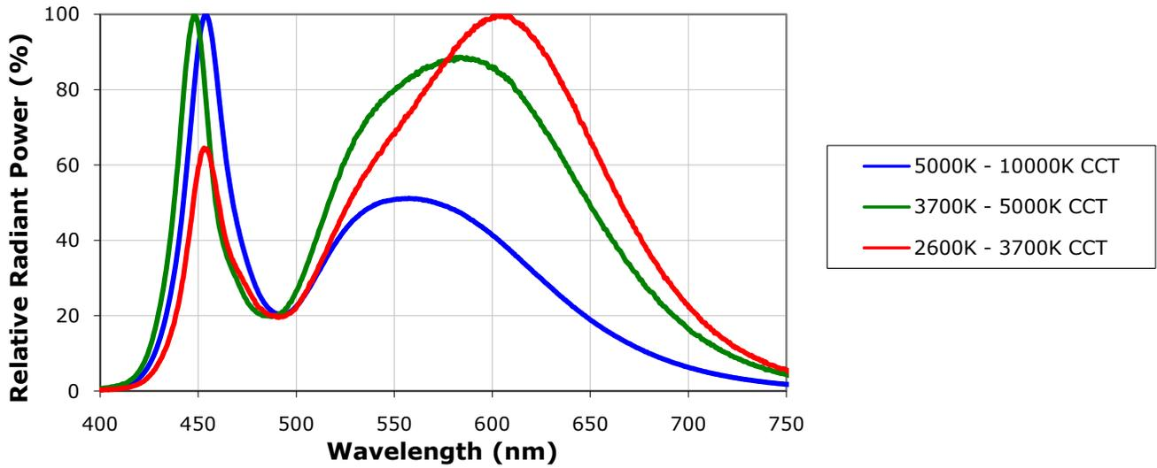
**RELATIVE SPECTRAL POWER DISTRIBUTION ( $I_f = 350$  MA PER LED) - COLOR**
