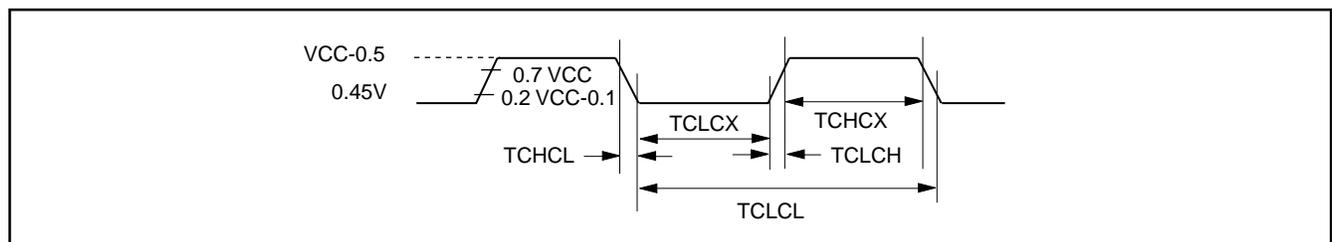
**AC TESTING INPUT, OUTPUT WAVEFORMS**
