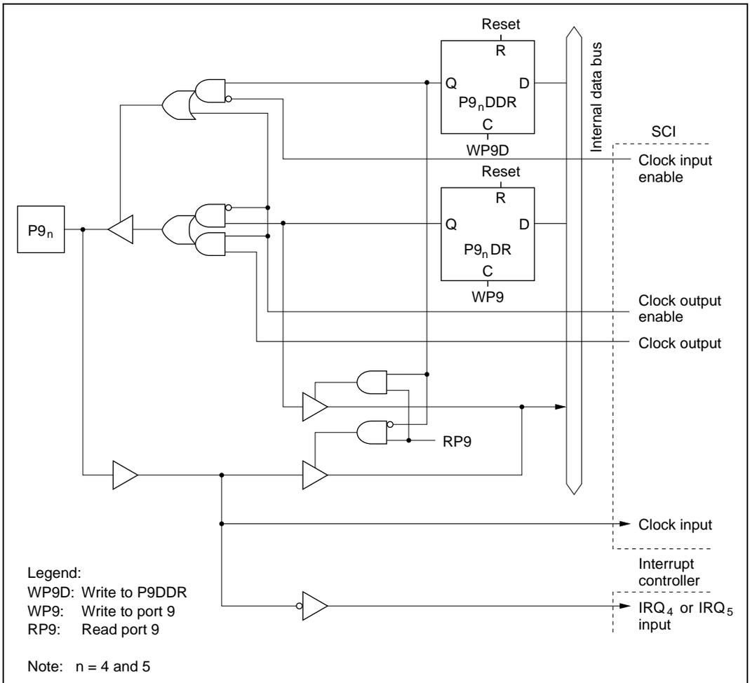
**Figure C.9 (d) Port 9 Block Diagram (Pins P9<sub>4</sub> and P9<sub>5</sub>)**
