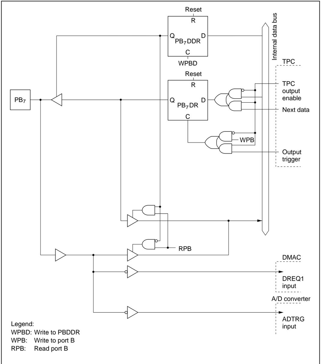
Figure C.11 (d) Port B Block Diagram (Pin PB<sub>7</sub>)
