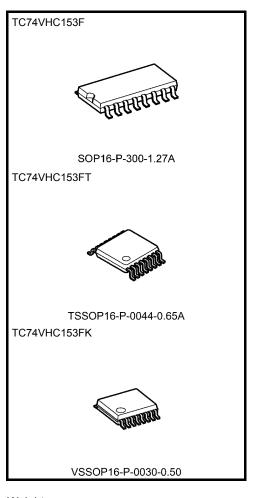
Weight SOP16-P-300-1.27A : 0.18 g (typ.) TSSOP16-P-0044-0.65A : 0.06 g (typ.) VSSOP16-P-0030-0.50 : 0.02 g (typ.)
