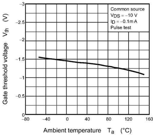
Fig. 8.1.9  $V_{th} - T_a$
