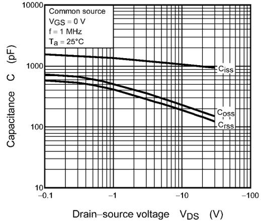
Fig. 8.1.8 Capacitance -  $V_{DS}$
