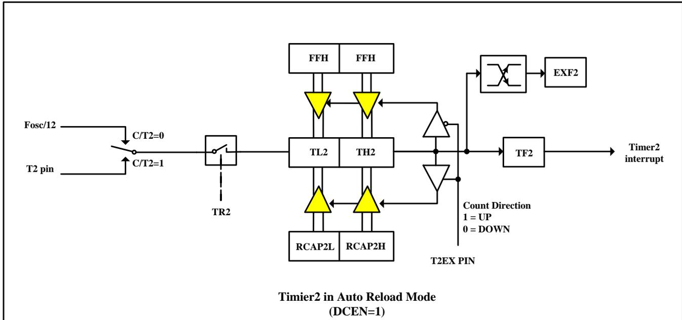
Fig. 7-3 : Timer 2 in auto reload mode (DCEN=1)
