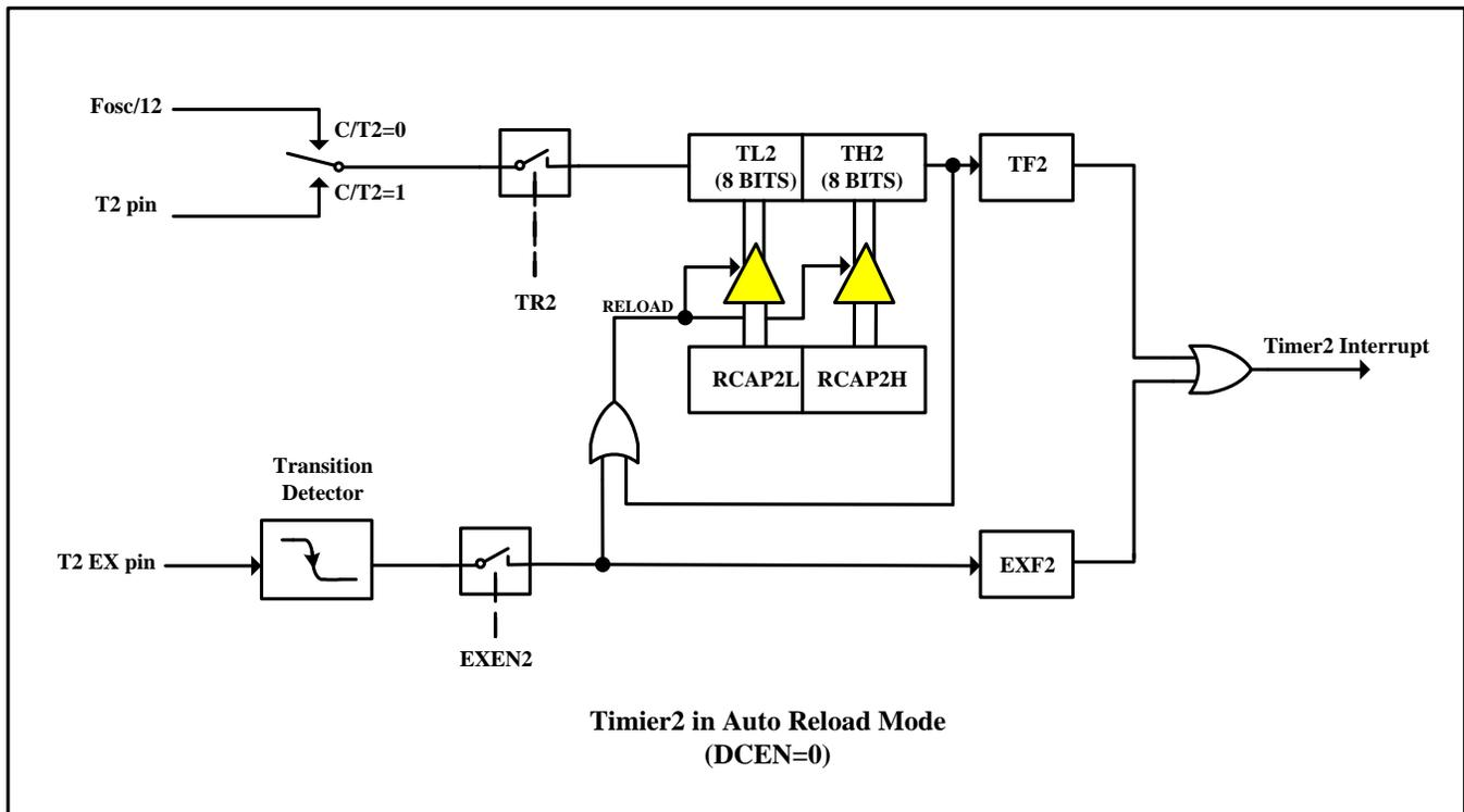
Fig. 7-2 : Timer 2 in auto reload mode (DCEN=0)
