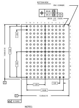
SOLDER PAD TYPE : NON-SOLDER MASK DEFINED (NSMD) PACKAGE WEIGHT :0.475g JEDEC REFERENCE : MO-216 / ISSUE E PACKAGE CODE : BB0AC
