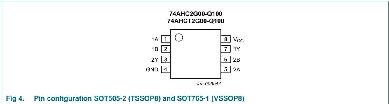
Fig 4. Pin configuration SOT505-2 (TSSOP8) and SOT765-1 (VSSOP8)
