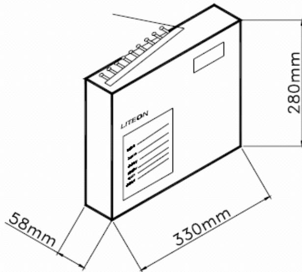
Tolerance:  $\pm 5\text{mm}$
