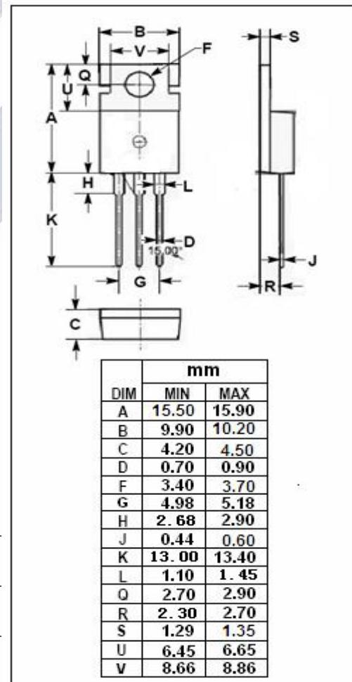
**isc N-Channel MOSFET Transistor****IRF3704Z, IIRF3704Z****ELECTRICAL CHARACTERISTICS** $T_c=25^\circ\text{C}$  unless otherwise specified
