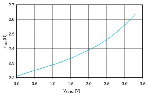
Figure 4. .  $r_{ON}(\Omega)$  vs  $V_{COM}(V)$
